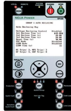
PANEL PRO LOKÁLNÍ OVLÁDÁNÍ
