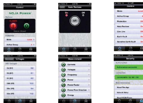
OBRAZOVKY APLIKACE PRO DÁLKOVÉ OVLÁDÁNÍ RECLOSERU NOJA POWER
