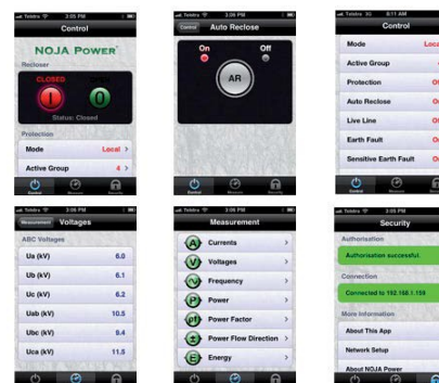
OBRAZOVKY APLIKACE DÁLKOVÉHO OVLÁDÁNÍ RECLOSERU NOJA POWER
